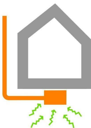
Figura 16: depressione del sottosuolo tramite pozzetto.
