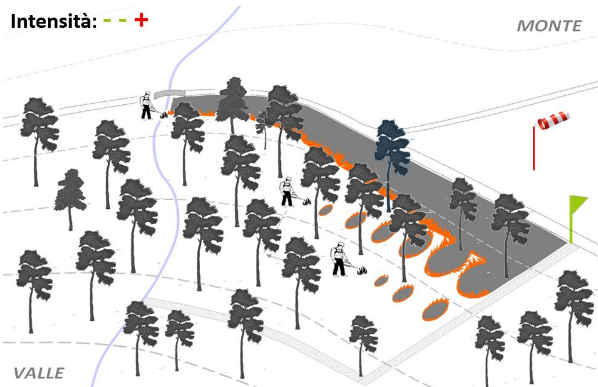
Figura 3. Tecnica di accensione per punti.
