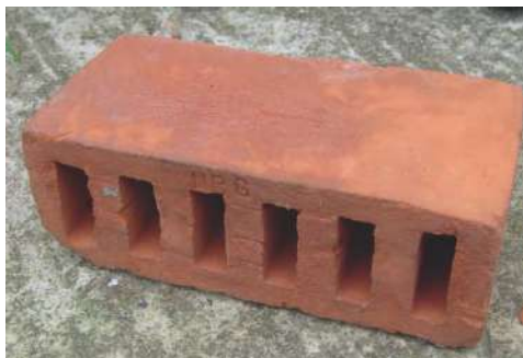
Esempio di bat box integrata nella struttura dell'edificio ( www.bats.org.uk ) e sistemazione di mattoni forati (English Heritage, National Trust and Natural England, 2009)
