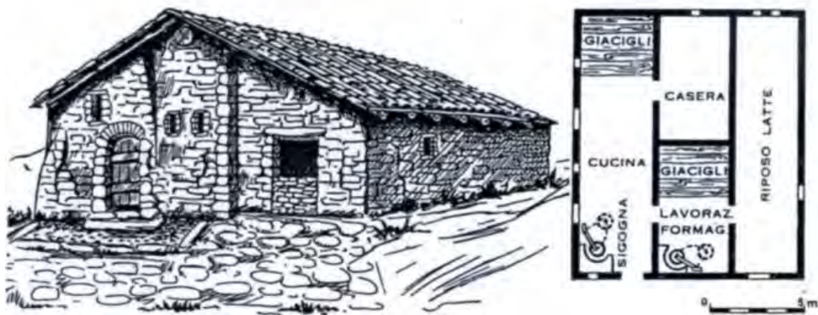
Prospetto e pianta di una baita dei pascoli in alta val Brembana (NANGERONI, PRACCHI, 1957, p. 32).
