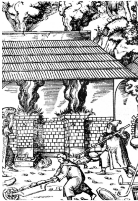
Forni di fusione del minerale (De Re Metallica di G. Agricola, 1494-1555) (FURIA, 2000, p. 26).
