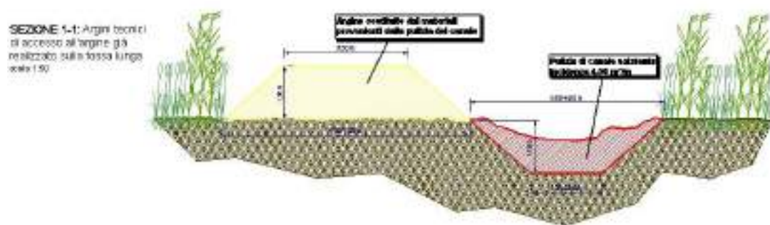
Figura 94 – Particolari costruttivi delle arginature.
