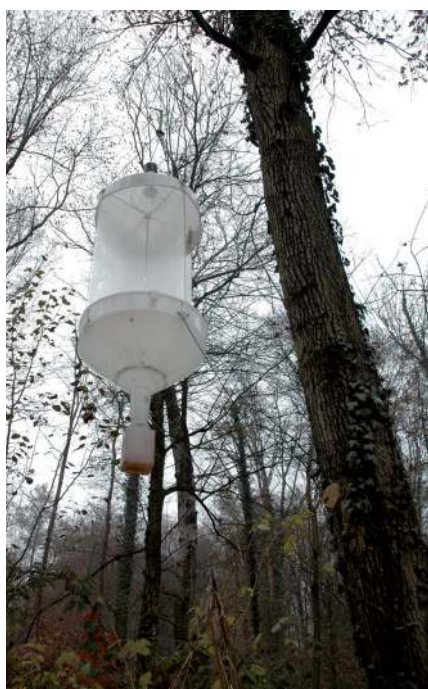
Trappola "window" installata nella RNBF per la cattura di Insetti volatori (foto A. Campanaro).
