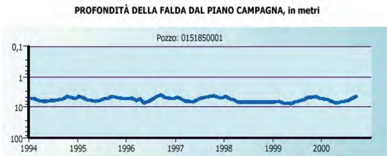
Fig. 2.1.6 - Variazioni della profondità di falda
