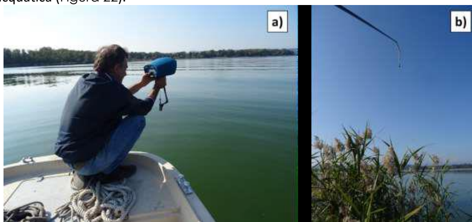
Figura 22. A sinistra acquisizione di firme spettrali delle acque con lo spettroradiometro WISP-3, a destra misure di radianza con lo strumento ROX sulla chioma di Phragmites australis .
