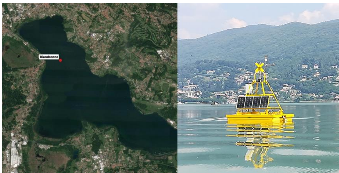
Figura 3. Ubicazione e foto della boa limnologica installata sul lago di Varese.
