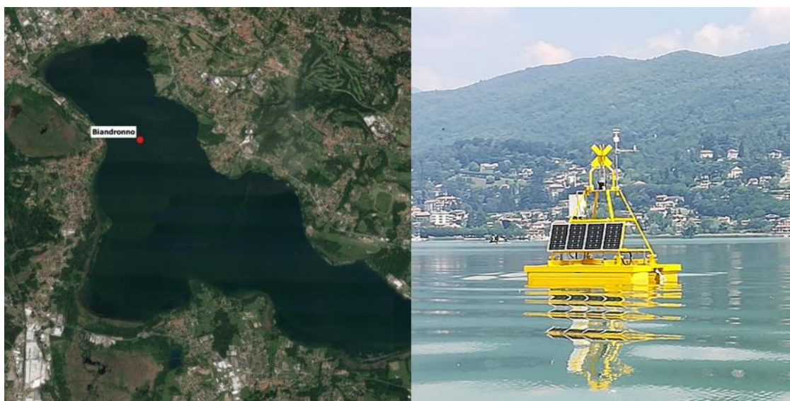
Figura 2. Ubicazione e foto della boa limnologica installata sul lago di Varese.
