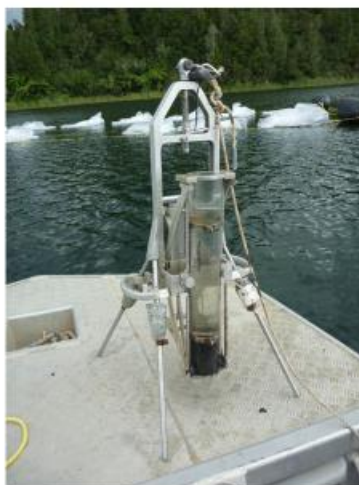
Esempio di carotatore (Jenkin)
