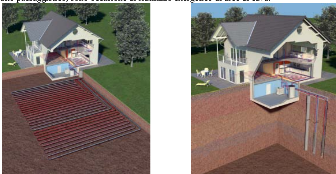
Fig 89. Schema di funzionamento di impianti geotermici con sonde in orizzontale e in verticale nel suolo adiacente. L'impatto paesaggistico è scarso.
