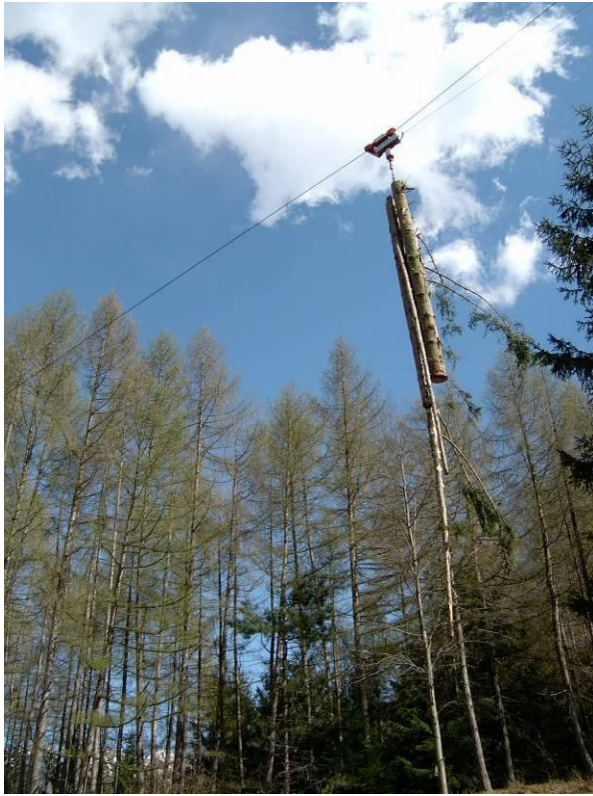
Trasporto di tronchi con teleferica (gru a cavo) per l'esbosco di legname già depezzato. Si noti il carrello. (foto Giulio Zanetti)
