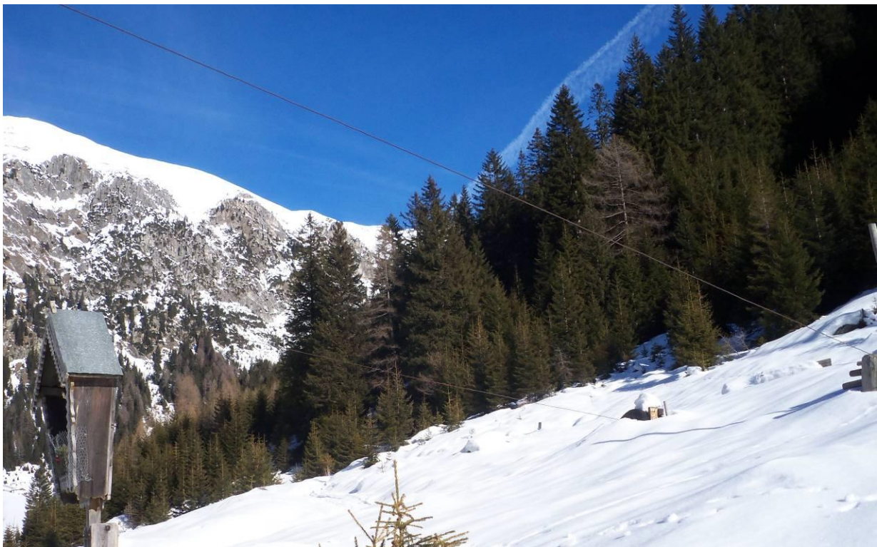
Palorcio (filo a sbalzo) per il trasporto di legname in Alto Adige. Si tratta di un semplice filo teso, spesso di difficile individuazione e pertanto molto pericoloso se non adeguatamente segnalato (foto Roberto Tonetti)
