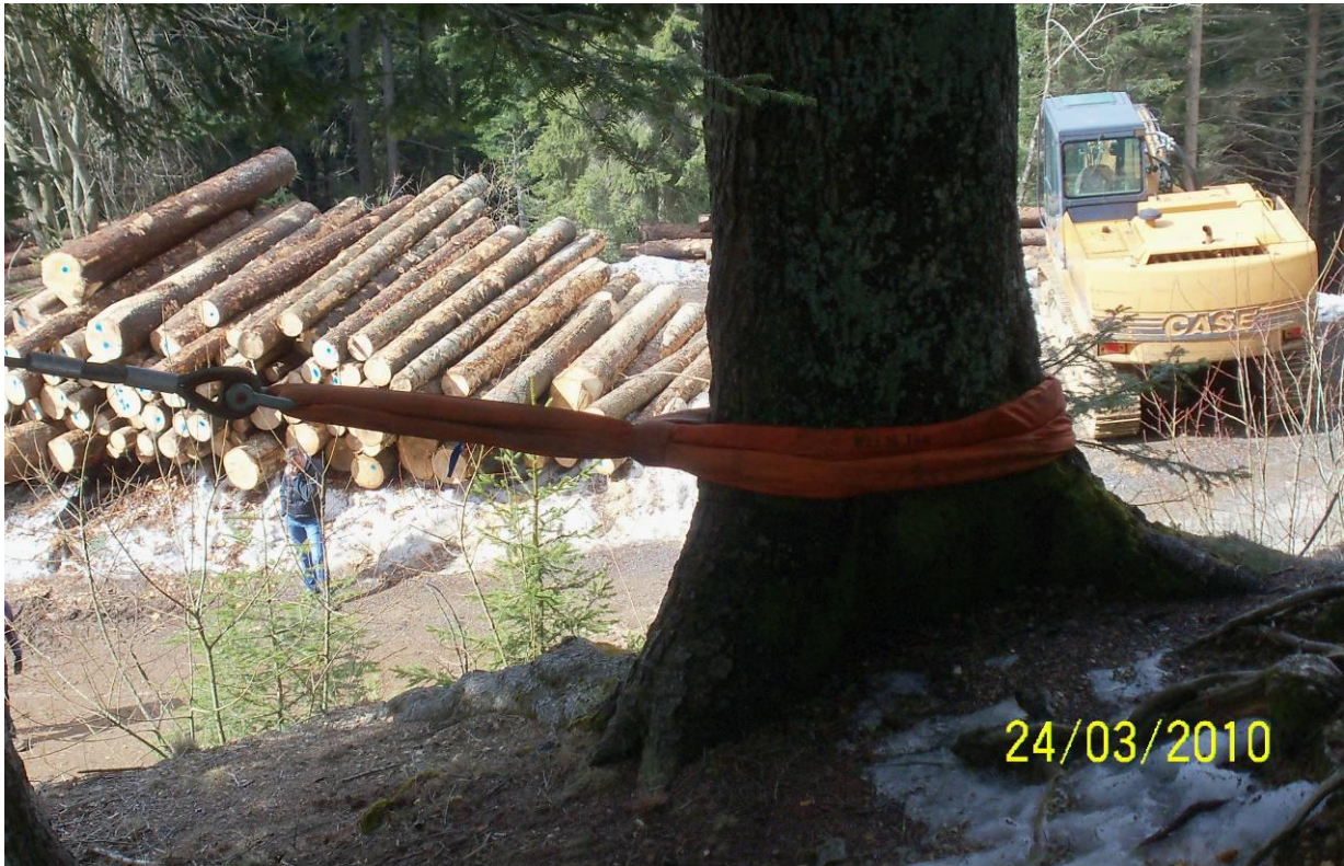
Al fine di evitare danni agli alberi da mantenere in piedi è necessario proteggere le cortecce con un'apposita "fascia elastica", come si vede in questa foto in val Brembana. (foto Roberto Tonetti)
