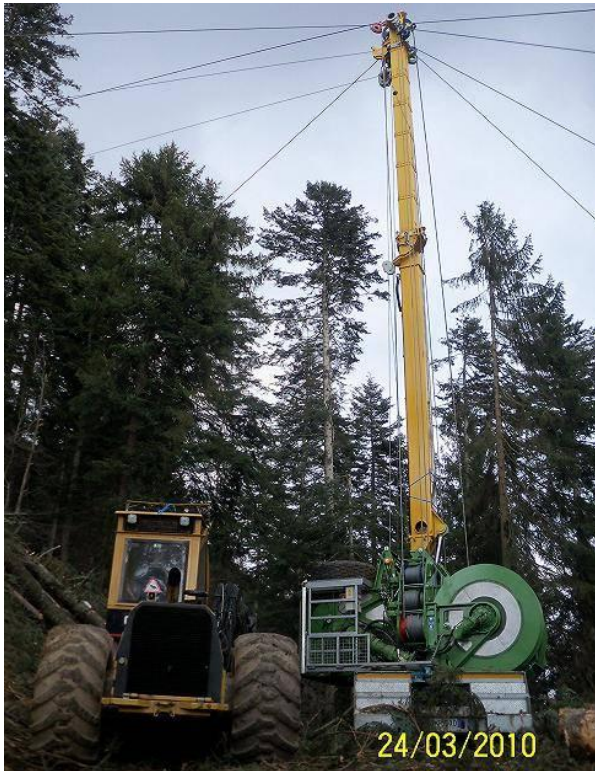
Teleferica (gru a cavo) per l'esbosco del legname in Val Brembana. La struttura in verde è un argano a torretta, fra i più alti che circolano sull'arco alpino. L'azienda l'ha acquistata grazie ai finanziamenti europei del Programma di Sviluppo Rurale della Provincia di Trento (foto Roberto Tonetti)
