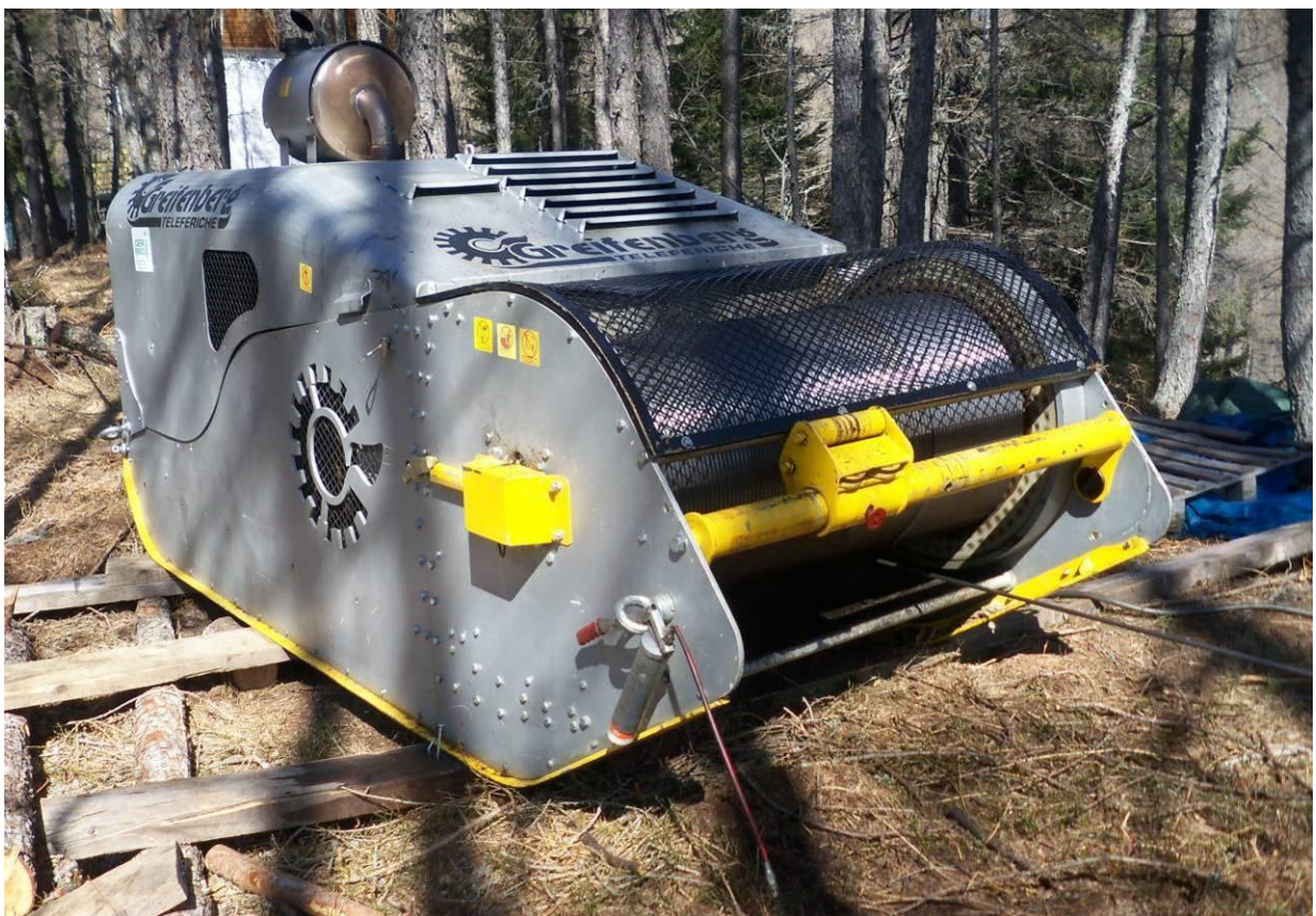
Argano. Permette di arrotolare e srotolare il cavo e quindi il carrello che trasporta i tronchi. Valvarrone. (foto Roberto Tonetti)
