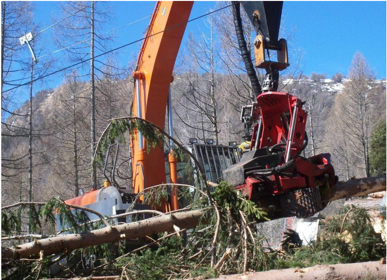
Quando il legname viene esboscato in tronchi interi e coi rami, è trasportato in un piazzale ove si procede alla sramatura e al depezzamento con apposite macchine, chiamate genericamente "processori". Valvarrone. (foto Roberto Tonetti)
