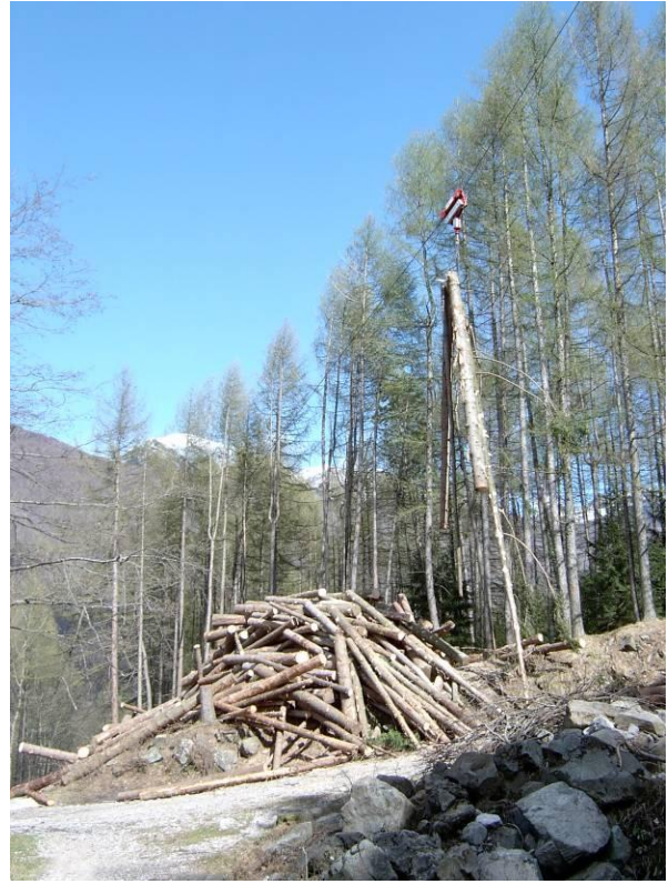
Punto di arrivo di legname già depezzato. Esso è depositato in una piazzola. (foto Giulio Zanetti)
