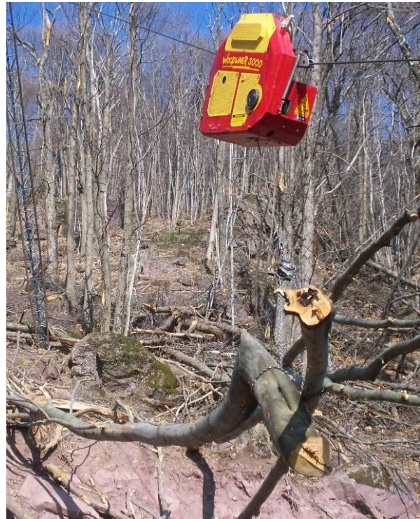
Carrello autotraslante per il trasporto di tronchi in "gru a cavo" in Valsassina. Si noti che il carrello, appoggiato al cavo portante e mosso dal cavo, aggancia i tronchi e li trasporta sia verso monte che verso valle, a scelta dell'operatore, che utilizza un telecomando da terra. (foto Roberto Tonetti)
