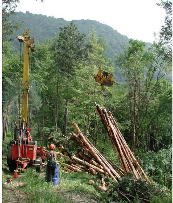
Trasporto di tronchi con "gru a cavo" in Valtellina. Quello rosso è un argano a torretta. Si notino i due cavi, una traente e uno che porta il "carrello" giallo, che aggancia i tronchi, portandoli da valle a monte.. (foto Tiziana Stangoni)
