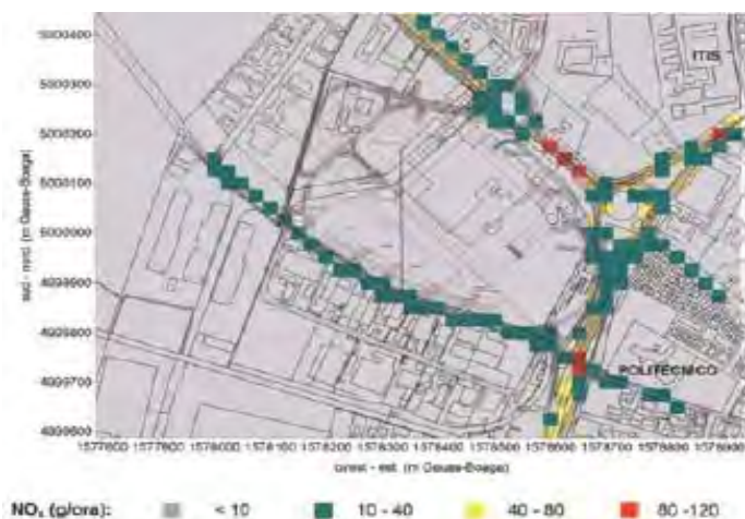
Modello di valutazione delle emissioni veicolari: scenario di progetto (ossidi di azoto)
