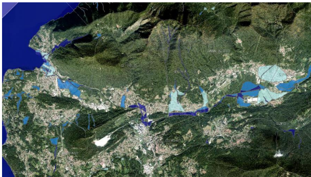
Figura 22 - Delimitazione aree allagabili nell'APSFR MUL_FD0015 - RL15 - da Laveno Mombello a Brenta - Torrente Boesio (in bianco il limite dell'APSFR) e Comuni interessati.
