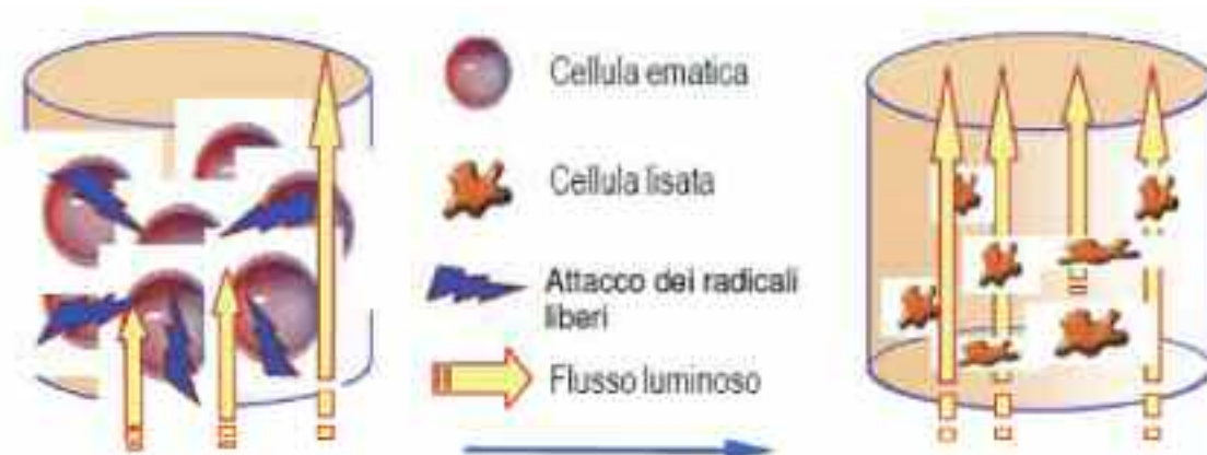
Figura 10. Meccanismo di azione del KRL test (Prost 1992)
