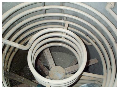
Figura 20 - Componenti interne di reattori di strippaggio: scambiatori e miscelatori
