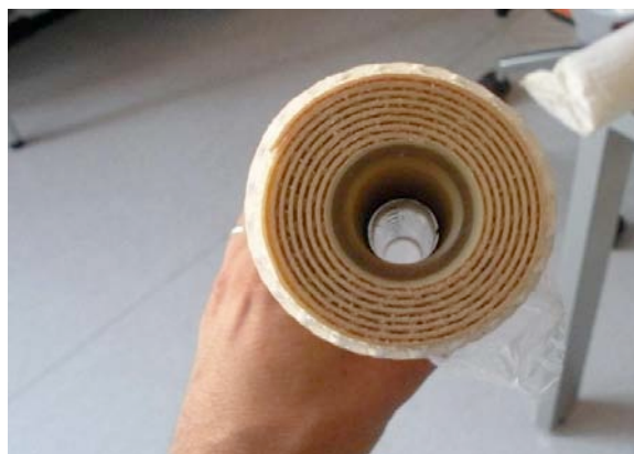
Figura 16 - La membrana impiegata per l'Osmosi Inversa
