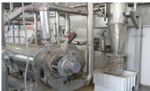
Figura 9 - Immagine dell'impianto di essiccazione utilizzato per le prove (ditta VOMM S.p.A.)
