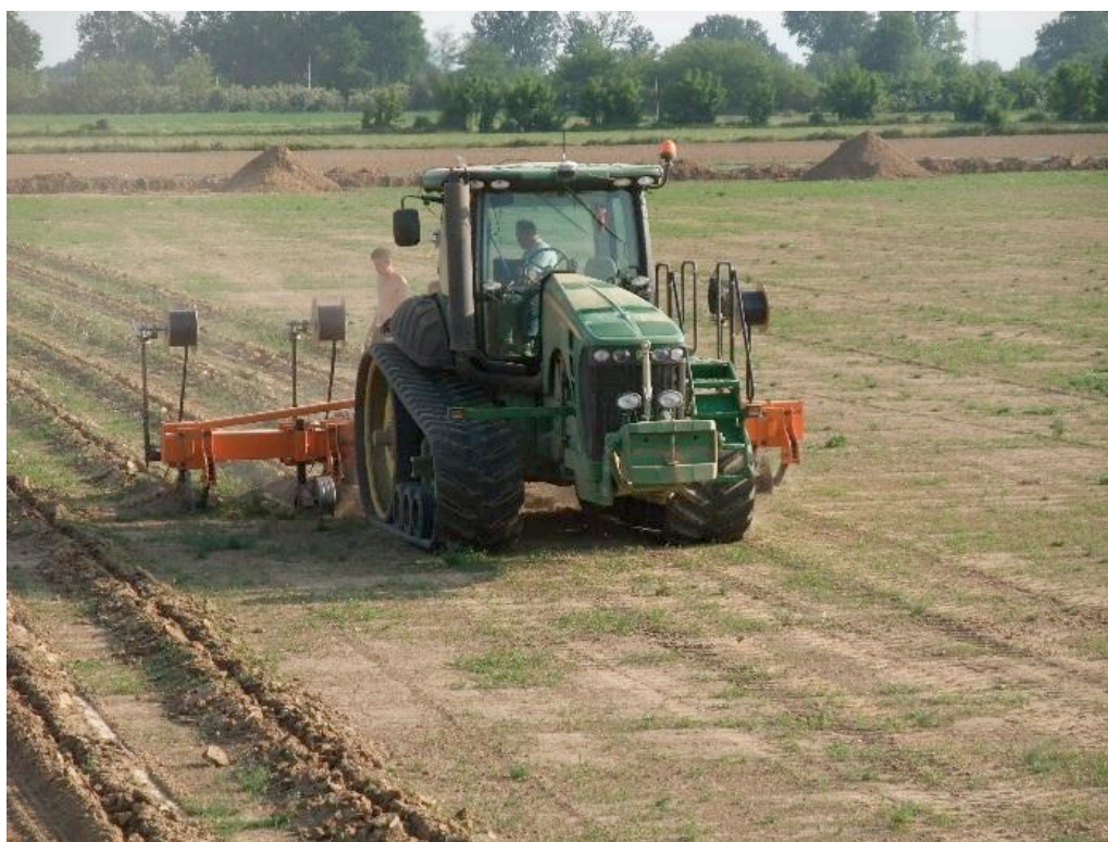
Figura 25 - Trattore munita di GPS e di attrezzo per l'interramento delle manichette (foto Underdrip)
