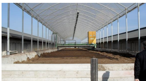
Figura 6 - Impianto di bio-essiccazione realizzato con tecnologia “Candiracci”
