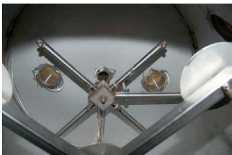
Figura 20 - Componenti interne di reattori di strippaggio: scambiatori e miscelatori
