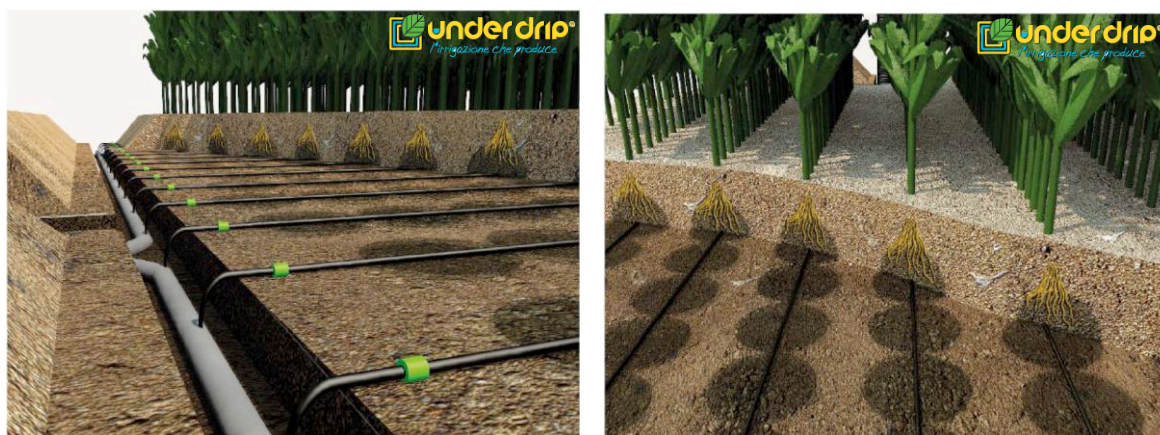
Figura 26 – Rappresentazione tridimensionale del sistema di subirrigazione con coltura di mais (disegni Underdrip)
