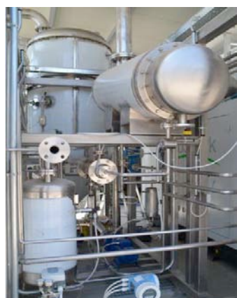
Figura 7 - Impianto di evaporazione sottovuoto con tecnologia Ecotecno
