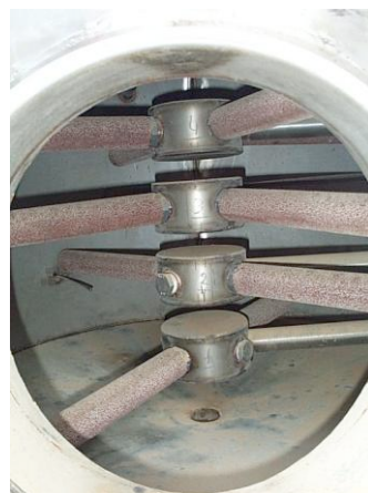
Figura 20 - Componenti interne di reattori di strippaggio: scambiatori e miscelatori
