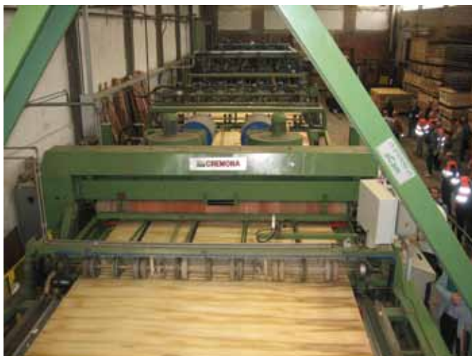
Figura 2. Sfogliatura di cloni di pioppo presso l'azienda Panguaneta di Sabbioneta (MN).
